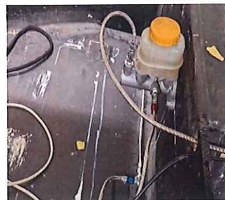
写真17 リザーバタンクとマスターシリンダー
